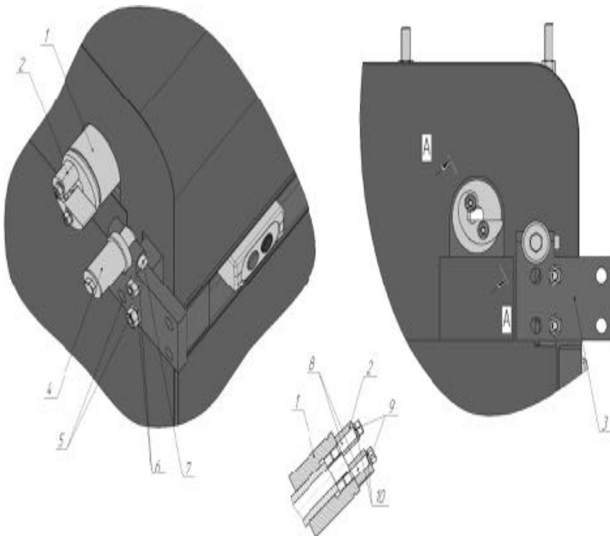
**Рис. 12. Монтаж приспособлений для выполнения операции по завивки в спираль прутка металлопроката.**
