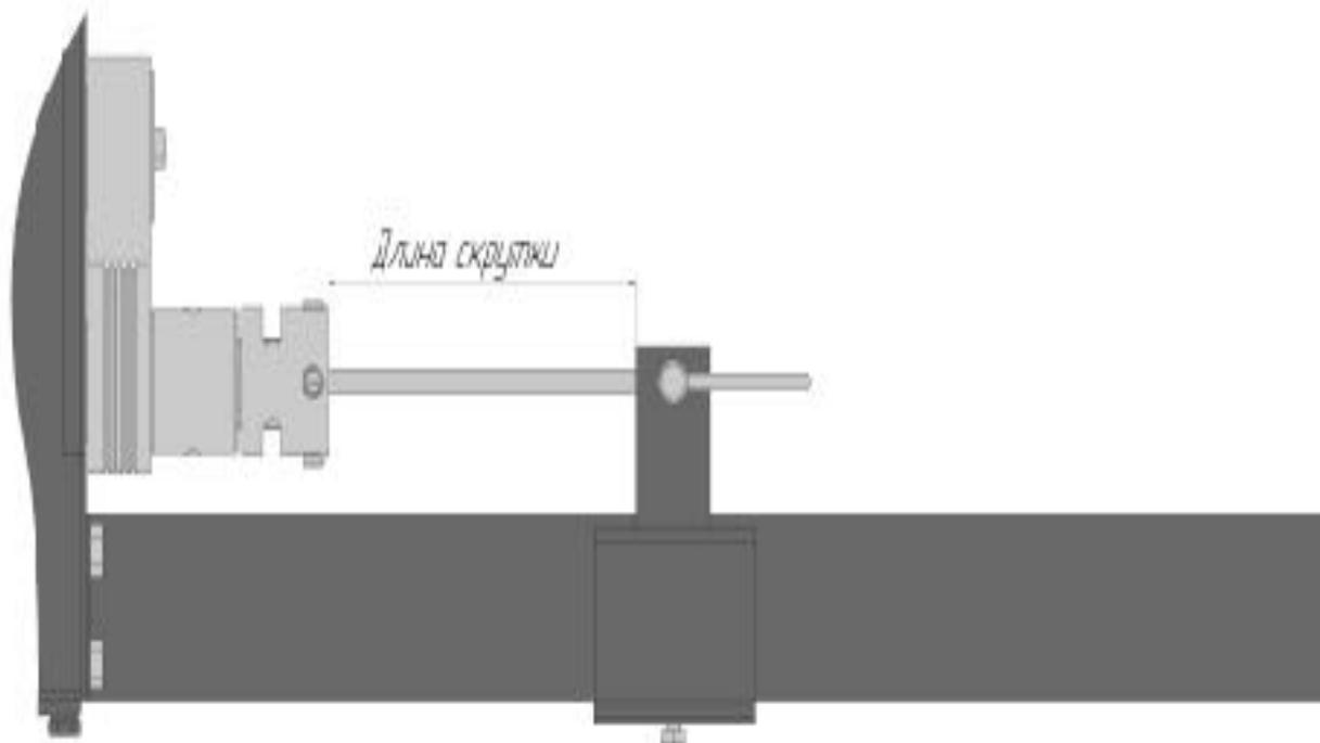
**Рис.4 Установка заготовки для операции продольного скручивания прутка.**
